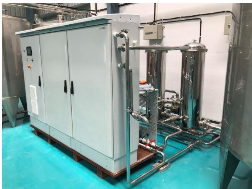
شکل ۲- نمونه ای از ژنراتور صنعتی تولید آب الکترولیز شده.
