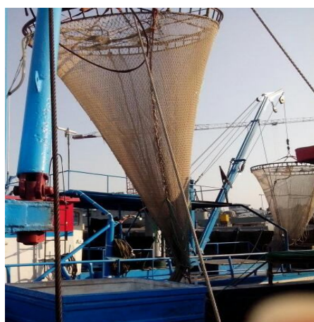
شکل ۳- صید ماهی کیلکای دریای خزر با استفاده از کشتی و تور قیفی- بندرانزلی (مؤلف، ۱۳۹۳).
